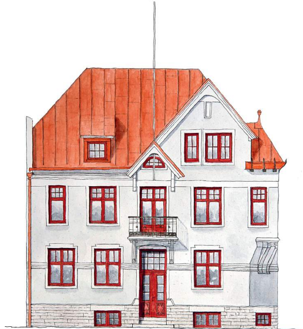
Fasad: bruten vit. Gesimser, omfattningar: vit. Fönster, dörrar: engelskt rött. Sockel: kalksten.
