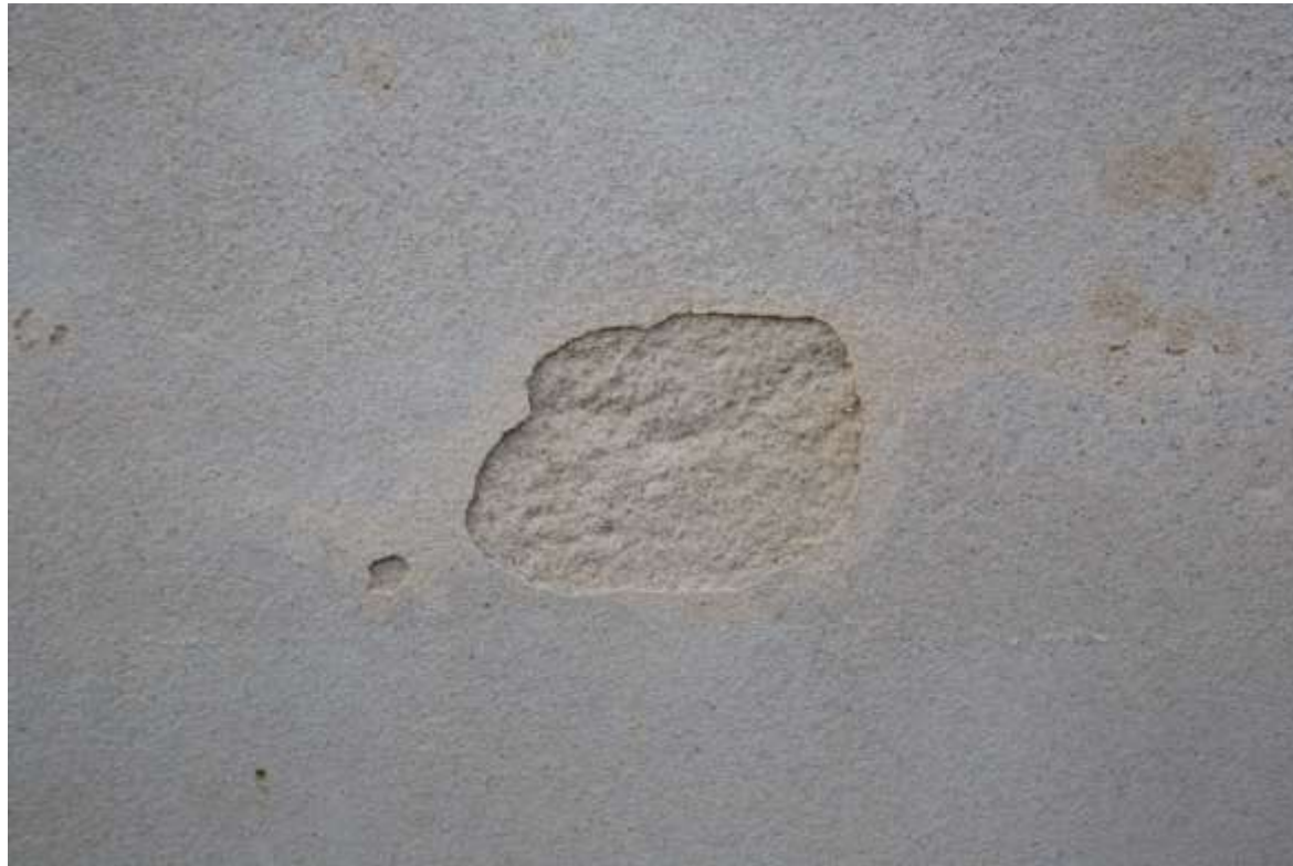
Prøvefelt nr. 5 – Hydraulisk kalk med tynd filtsning
