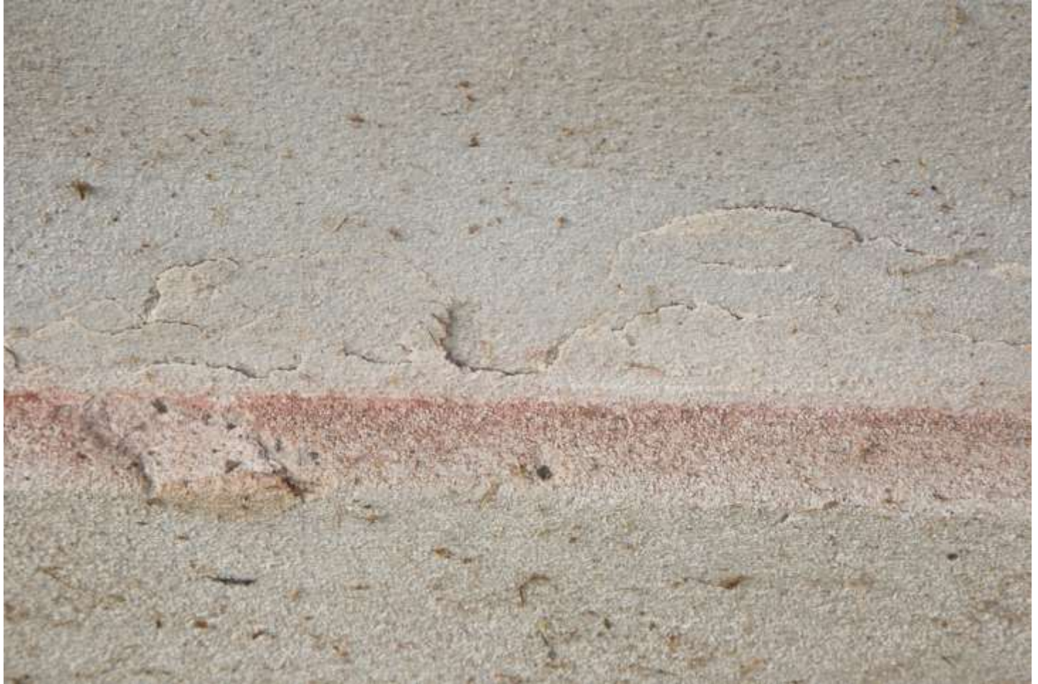
Prøvefelt nr. 5: Hydrauliske kalkmørtel KKh 35/65/500 (1 del kulekalksmørtel KI00/750 til 3 dele jurakalk – filtset med sandkalk)
