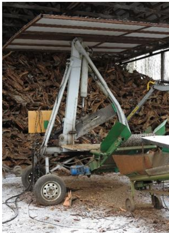
Figur 6: Med den stora hydrauliska kniven skärs stubbarna i småbitar.
