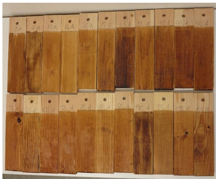
Figur 28. uppstrykningsprov på hyvlad furu med prover från Ardre såide.
