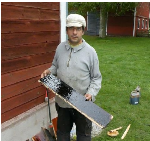
Inkokningsförsök med olika tjäror.
