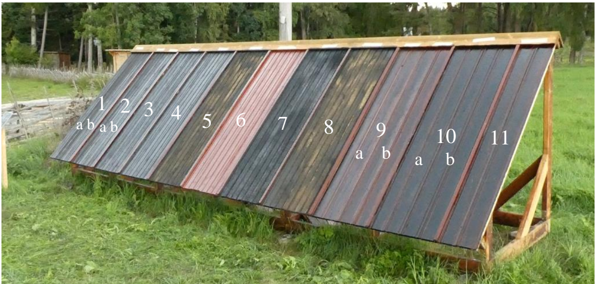
Tak med numrerade provtytor för olika tjärblandningar, Norrbys Kulturresevat. Taget den 30 aug.
