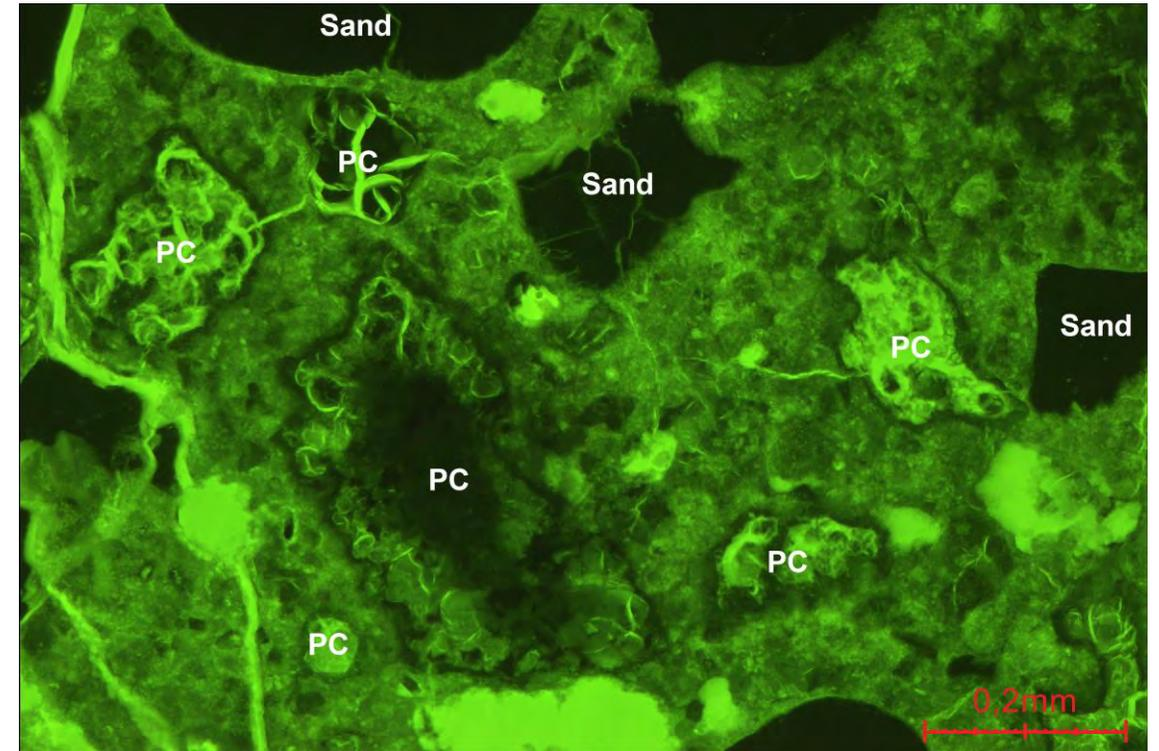
Hydration of cement:  $2\text{Ca}_3\text{SiO}_5 + 7\text{H}_2\text{O} \rightarrow 3\text{CaO} \cdot 2\text{SiO}_2 \cdot 4\text{H}_2\text{O} + 3\text{Ca}(\text{OH})_2$
